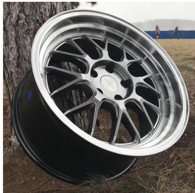
轮毂不同制造工艺的区别：重力铸造非常简单，将液态的金属倒进轮毂模具中冷却成型。这种铸造方式效率非常高，成本也低，但是质量比较差，由于轮毂的各部分分布不是很均匀，而且金属内部分子的密度比较低，所以轮毂的强度不高，碰撞后很容易出现断裂的情况；低压铸造是在重力铸造的基础上进行了一个升级，将液态的金属倒入模具之后，给它施加一个恒定的压力，使金属的分子密度增高，轮毂成型之后会有更高的强度，且低压铸造的工艺也非常成熟，所以目前大部分车型上的轮毂采用的都是低压铸造工艺；旋压铸造是将铸造后的轮毂进行一个二次加工，将轮毂一边加热一边进行旋压加工，这样可使轮毂内的金属分子更加紧密，强度也更高。所以，这三种工艺的轮毂重量，旋压轮毂<低压铸造轮毂<重力铸造轮毂。
