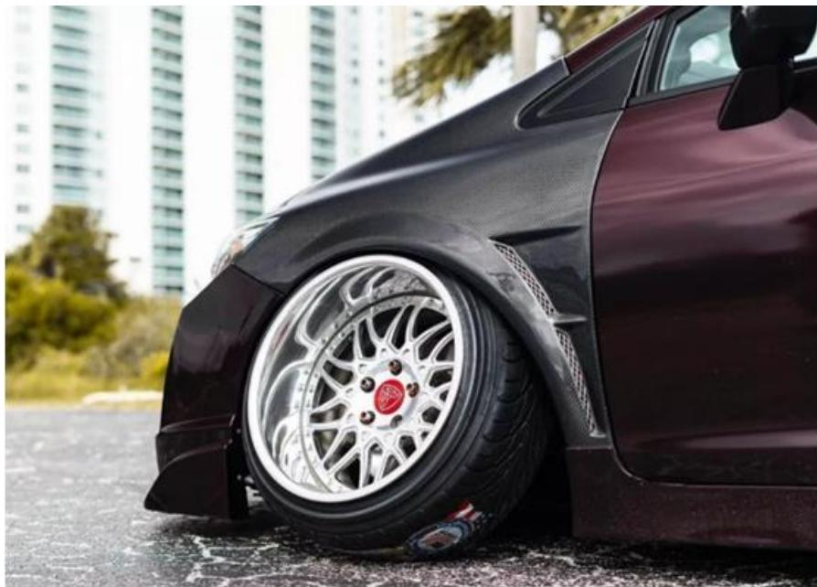
两片式旋压轮毂的优势：两片式旋压轮毂由轮辋和轮幅两部分组成。作为改装车轮毂，它可以在一个轮毂上组合不同宽度和厚度的轮圈，也可以结合宽度和偏移量来获得更多的选择方案。并且两片式轮辐可以互换，维修和更换时，不需要更换整个轮毂，只需更换部分即可，\*\*终用\*\*度螺栓进行紧固。除此以外，由于轮毂的轮辋及中盘分开，方便使用一些复杂的表面处理工艺，造型也更复杂多变，更炫。两片式轮毂组合工序的复杂性，使得对工厂的生产能力要求更高，能做出合格的两片式产品，足见尚晞科技的工厂实力。
